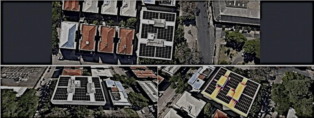
VISÃO GERAL DO SISTEMA  192 Módulos FV  1 Inversor  98 Otimizadores
